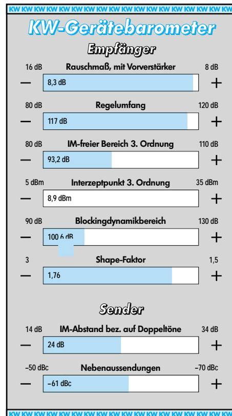
Oberhalb 30 MHz wurde mit eingeschaltetem Vorverstärker gemessen, da Monobandgeräte in diesen Frequenzbereichen den VV fest integriert haben (nicht schaltbar)
